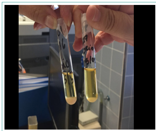
Figura 3. Precipitado en tubo con suero y sin suero tras 24 horas en frío
